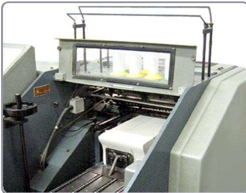
Figura B.15 – Máquina para costura (Fonte: ver lista de créditos de imagens 13)
