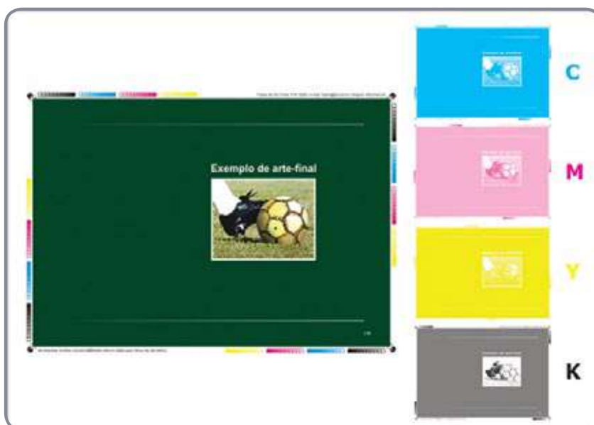
Figura B.1 – Exemplos de impressão em seleção de cores.
