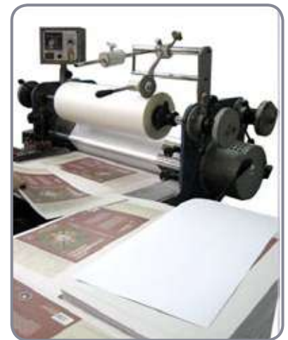
Figura B.17 – Máquina plastificação e termolaminação (Fonte: ver lista de créditos de imagens 15)
